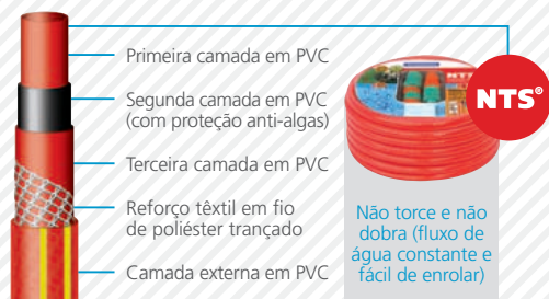
MANGUEIRA DE 5 CAMADAS Resistente até 18 bar (261 psi) e 50 °C
